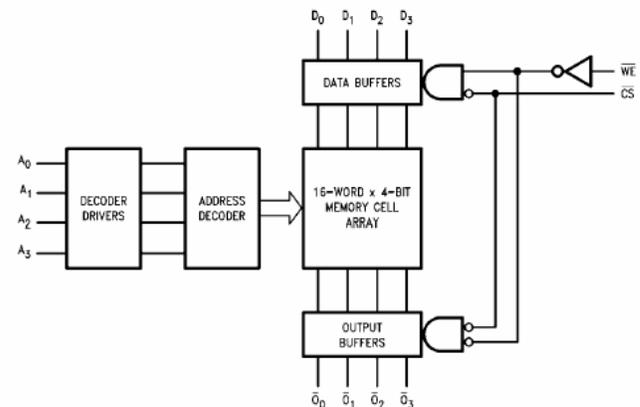
Fig. 5 74F189 RAM Block Diagram
