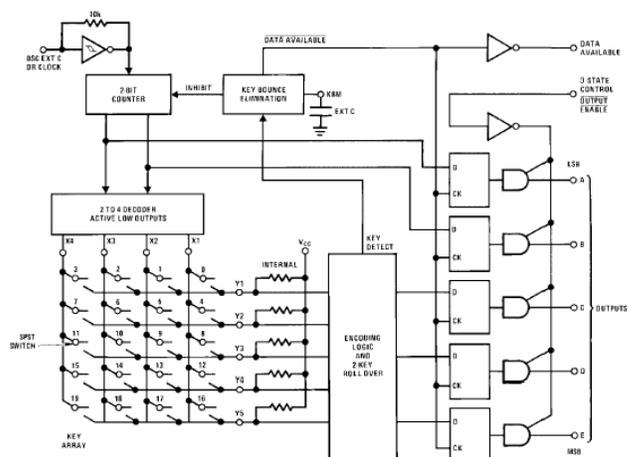
Fig. 1. MM74C92 Block Diagram
